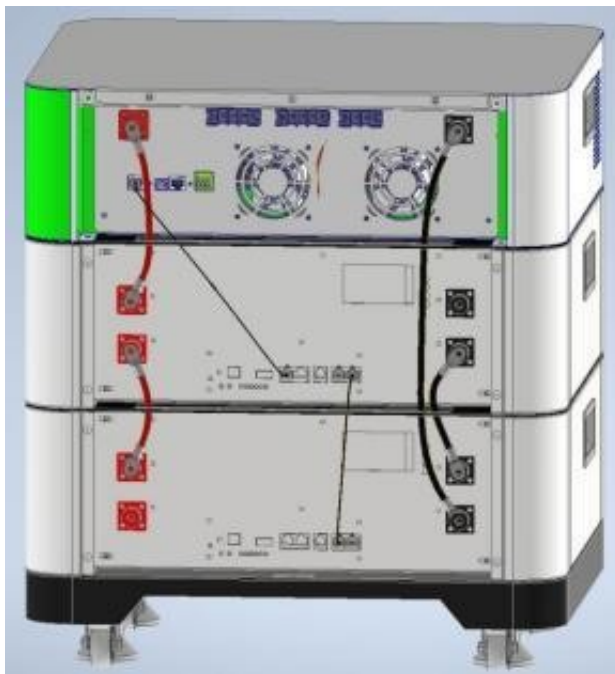
Рисунок 6-6. Исходная схема силовых и коммуникационных соединений, шаг 3.
