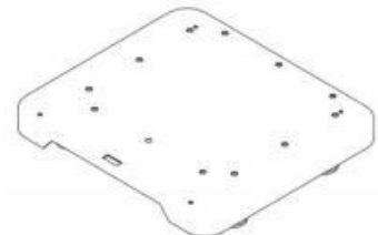
Рисунок 6-2. Недопустимая ориентация инверторного модуля, аккумуляторного модуля и основания.
