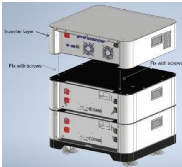
Рисунок 6-5. Установка инверторного модуля, шаг 3.
