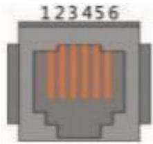
Рисунок 4-9. RJ11 с исходной нумерацией контактов 1-6.
